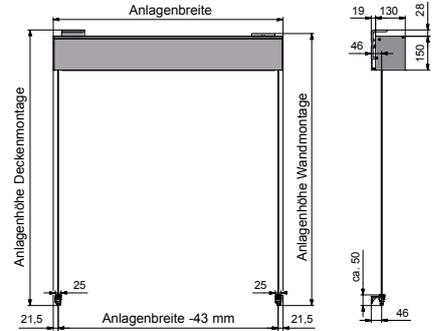
EINZEL-SEILABSPANNUNG GEFEDERT NACH UNTEN MK-417
