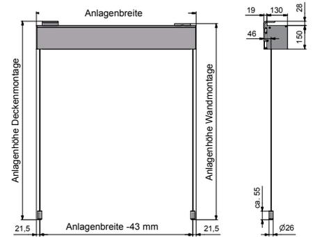
KOMBINATION FÜHRUNGSSCHIENE-SEILABSPANNUNG GEFEDERT MK-418
