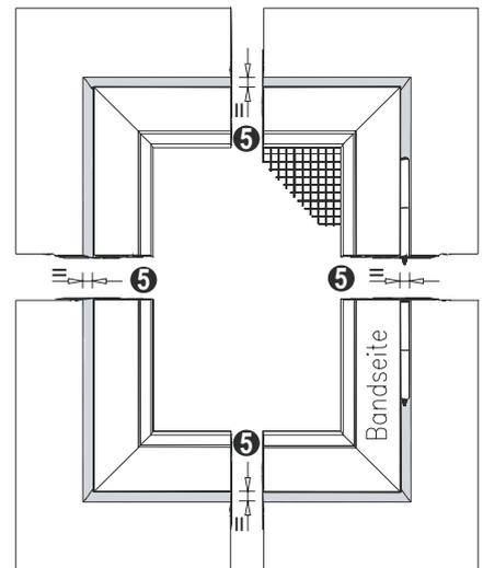
**Achtung:** Die Drehbandstifte müssen vor der Montage mit NEHER-Beschlagsspray eingefettet werden. Die Stifte sind leicht gebogen. Damit ist gewährleistet, dass diese spielfrei sitzen und das Drehband sich geräuscharm bewegt.
