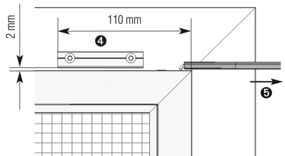
Drehrahmen öffnen und geöffnet halten. Schutzschlauch von der Drehstabfeder entfernen (abziehen) **5** und Drehstabfeder in den Drehstabführungshalter von unten her einhängen. **Vorsicht: Drehstabfeder ist vorgespannt!** Türschließer durch öffnen und schließen des Drehrahmens auf Funktion prüfen.
