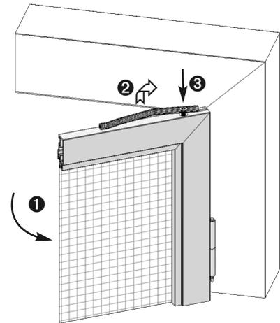
Sicherungsschraube **3** bis zum Anschlag eindrehen und Drehrahmen schließen.
