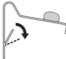
→ Den Glasleistencip so fest zwischen Glasscheibe und Glasleiste drücken, dass die Halteplatte auf die Glasleiste aufstößt. Es muss bei einigen Fenstertypen mit einer gewissen Kraftanwendung gerechnet werden.
